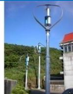
Verificare sempre le condizioni del tetto (se installazione su edificio) o del suolo (se installazione a terra) prima di procedere, le misure consigliate per installazione su tetto sono altezza palo 3mt mentre a terra altezza palo 4mt. Controllare sempre l'area circostante in modo da evitare l'installazione in prossimità di ostacoli che possano influire negativamente sulla velocità e forza del vento nella zona.
